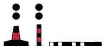
Рис. 20 Знаки, ограждающие отдельные опасности
