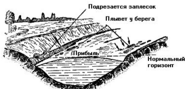
Рис. 27. Схема живого течения при убыли и при резкой прибыли воды
