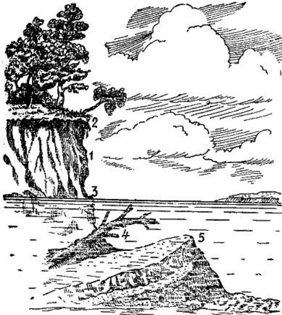
Рис. 13. Нечистый яр: 1 — яр; 2 — бровка яра; 3 — урез воды; 4 — свалившееся дерево; 5 — подводная пещина
