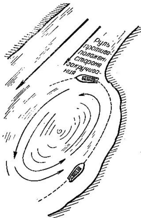
Рис 125 Вывод судна из суводи
